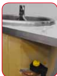
Valvola per il controllo del raffreddamento di metà vasca per mod. 36 e 56
